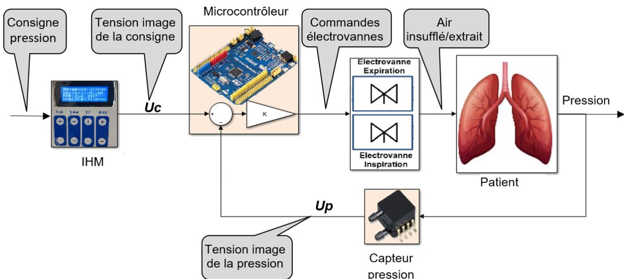
Figure 10 : modèle multi-physique en boucle fermée
