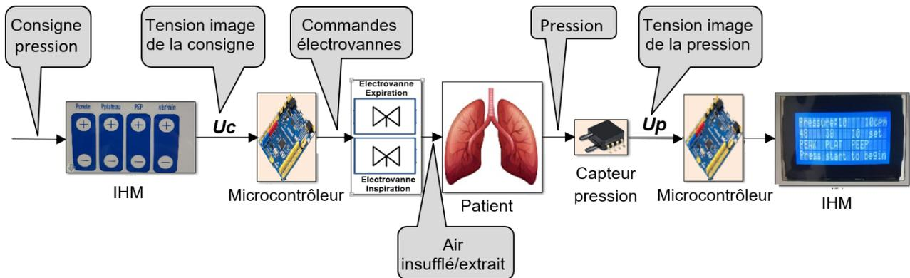
Figure 8 : modèle multi-physique en boucle ouverte
