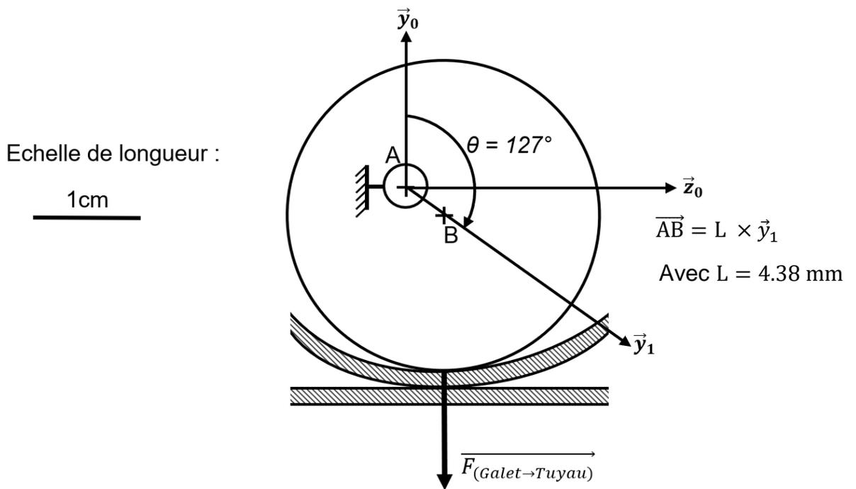
Figure 24 : force d'écrasement du tuyau par le galet
