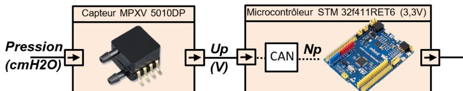
Figure 7 : chaîne d'acquisition de la pression
