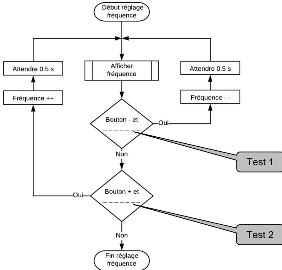
Figure 19 : algorithme de réglage de la fréquence respiratoire
