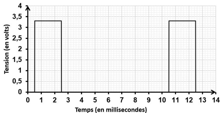
Figure 23 : signal de commande MLI, vanne fermée
