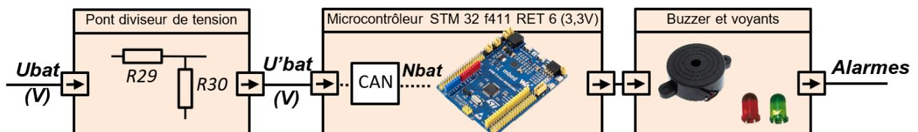
Figure 16 : chaîne d'acquisition de la tension batterie
