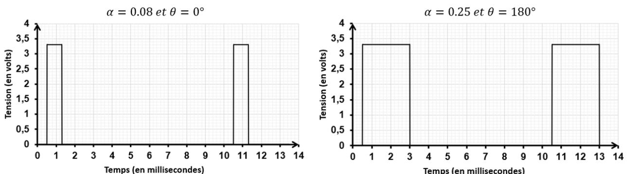
Figure 22 : signal de commande MLI du servomoteur
