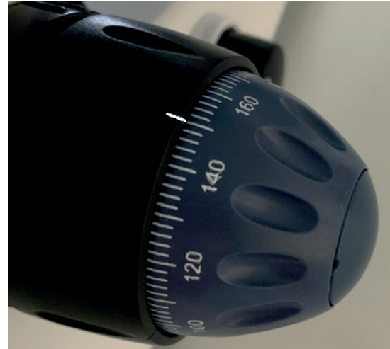
Figure 3. Photographies de la vis micrométrique
