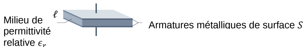
Figure 2 : Représentation schématisée d'un condensateur plan
