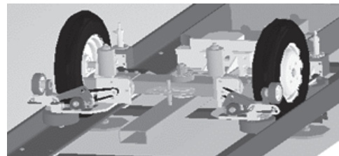
Figure 3 : vue du système de guidage sur le rail
