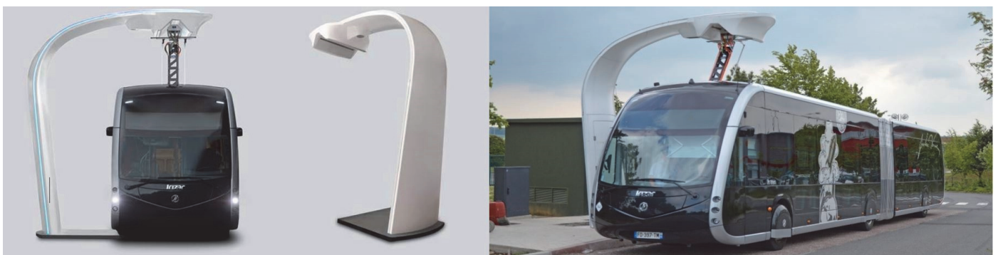
Figure 2 : bus NEMO avec le pantographe déployé
