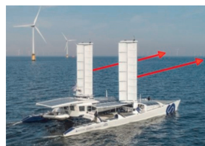
Figure 13 : propulsion de l'Energy Observer avec les Oceanwings
