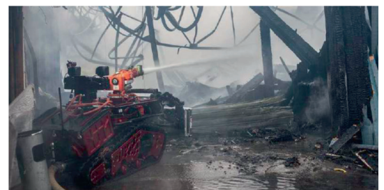
Figure 7 : Colossus version canon à eau + tourelle vidéo
