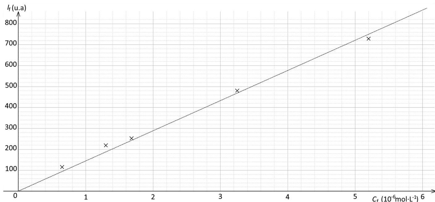
**Étape 3 :** L'intensité de fluorescence mesurée pour une solution de Schweppes® diluée 100 fois est égale à 319 u.a.
