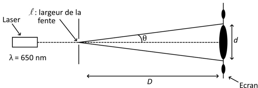
Figure 2. Schéma du montage expérimental vu du dessus
