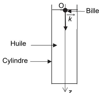
Figure 1. Schéma du dispositif expérimental de mesure
