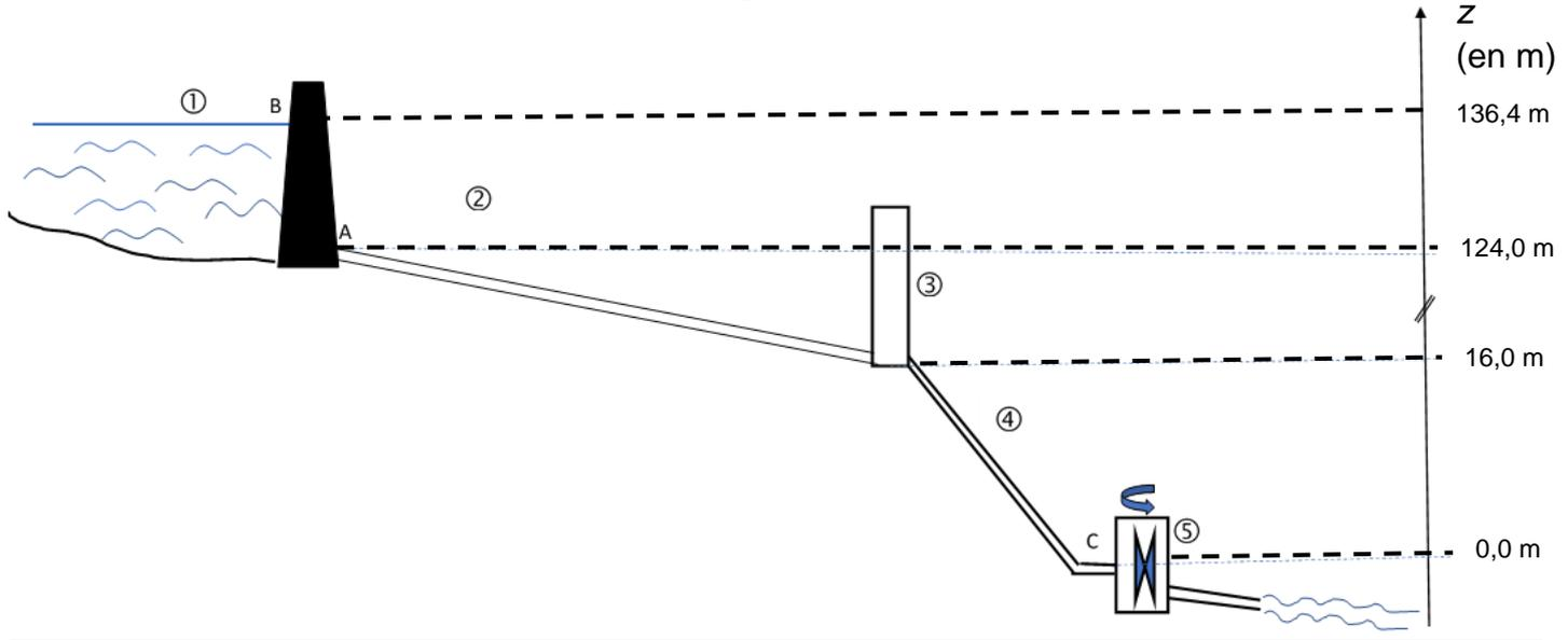
La retenue, où est stockée l'eau à turbiner, est le barrage de Record ①, hameau situé à quelques kilomètres en amont. L'eau est acheminée par une conduite d'amenée ②, et passe brièvement dans une chambre d'équilibre de forme cylindrique ③ et est envoyée sur deux turbines identiques ⑤ par une conduite forcée ④.
