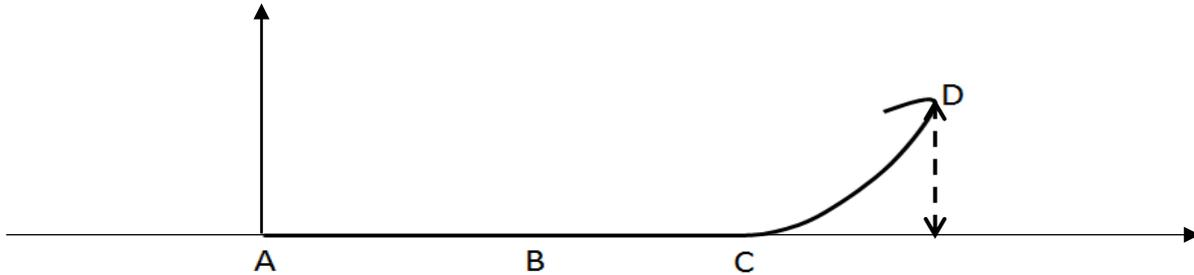
Le train est initialement immobilisé au point A avec la vitesse initiale  $v_0 = 0 \text{ m.s}^{-1}$ . Grâce à un moteur linéaire électrique il est accéléré, sur une piste horizontale, par une force constante entre les points A et B pendant une durée  $\Delta t = 2,5 \text{ s}$  pour atteindre sa vitesse maximale  $v_{\max}$  au point B. À partir du point C, il parcourt la première montée pour atteindre son sommet au point D à une hauteur  $h = 38 \text{ m}$  au-dessus de la piste de lancement.
