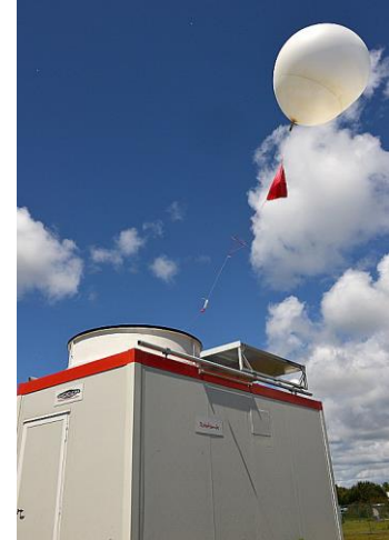
Figure 1 : lâcher de ballon automatique © Météo-France, Pascal Taburet
