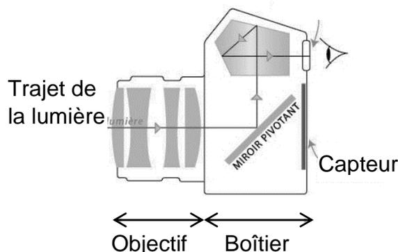
Pour simplifier, l'objectif peut être modélisé par une lentille mince convergente unique, dont la distance focale est égale à celle de l'objectif. Les distances sont donc exprimées par rapport au centre optique de cette lentille.
