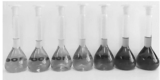
Un traitement des données expérimentales acquises par l'interface d'acquisition, permet à la technicienne d'obtenir la valeur de l'absorbance  $A$  de chaque solution étalon. Elle trace le graphe représentant l'évolution de l'absorbance  $A$  en fonction de la concentration  $C$  de la solution en permanganate de potassium. Le graphique est donné en annexe. Indiquer si avec la gamme étalon utilisée, la relation de Beer-Lambert peut s'appliquer.
