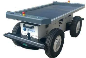
Effibot est en permanence protégé par un système anticollision, fonctionnant à 360° autour du véhicule, qui lui permet d'éviter et de contourner automatiquement tout obstacle qu'il aura détecté dans son environnement.
