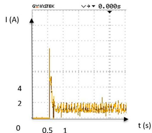
La figure ci-contre présente l'évolution de l'intensité du courant délivré par la batterie de la voiture lors de l'essai d'étalonnage.
