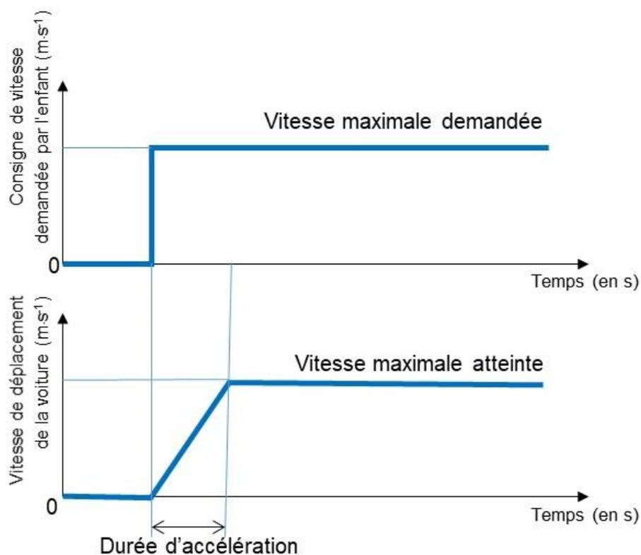
La solution technique choisie consiste à implanter un interrupteur sous la pédale de commande. L'information électrique issue de la pédale est transmise à un microcontrôleur qui pilote un hacheur de tension en vue de moduler l'énergie électrique distribuée au moteur. La transmission mécanique est assurée par un réducteur de vitesse.
