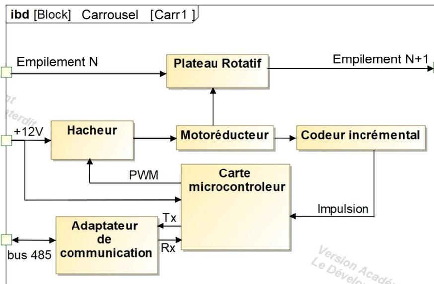
Figure 7 : diagramme des blocs internes du carrousel
