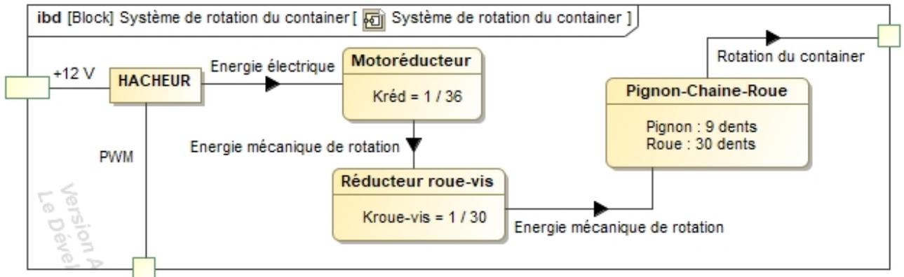
Figure 6a : chaîne de puissance du système de rotation du container
