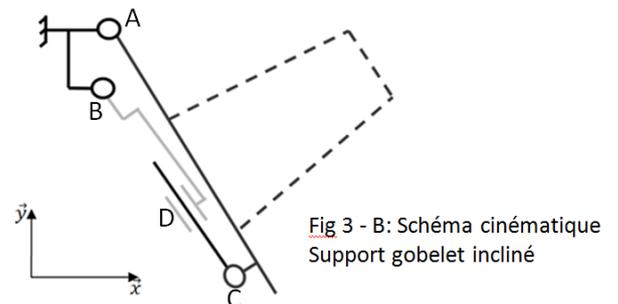
Le schéma cinématique retenu par les concepteurs du système pour transférer un gobelet vers la zone de stockage est représenté sur la figure 3.
