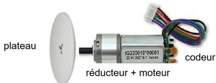
Figure 9 : motoréducteur avec codeur incrémental.
