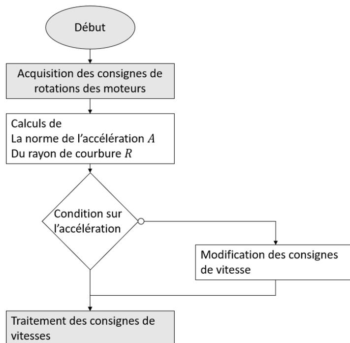
Fig.3 : Algorithme fonctionnel
