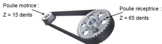
Figure 4 : Caractéristiques du système poulies / courroie
