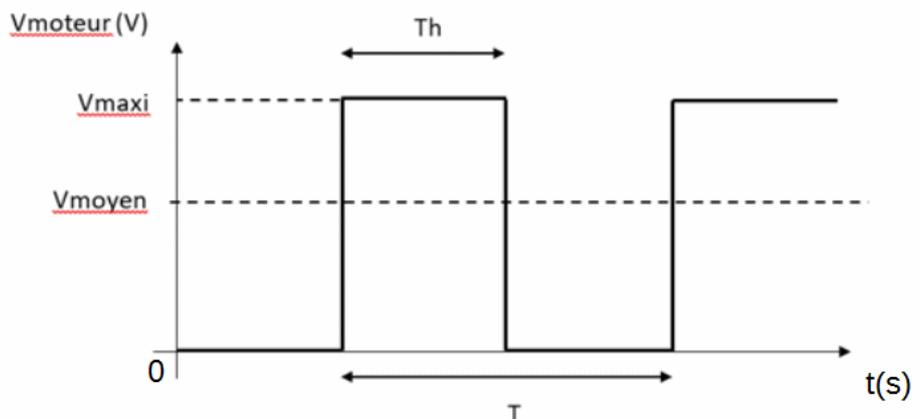
Figure 9 : Signal électrique de commande du moteur
