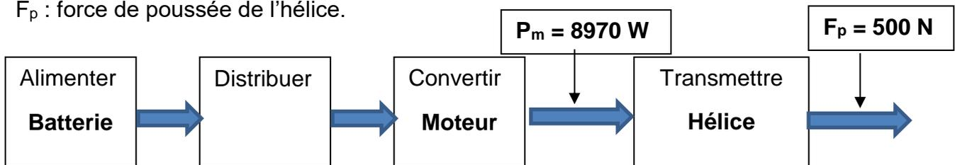
Figure 6 : modélisation de la chaîne de puissance partielle
