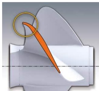
Figure 7 : une hélice est formée de pales s'apparentant à un foil
